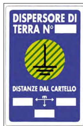
Tipico cartello per l'indicazione della posizione del dispersore
