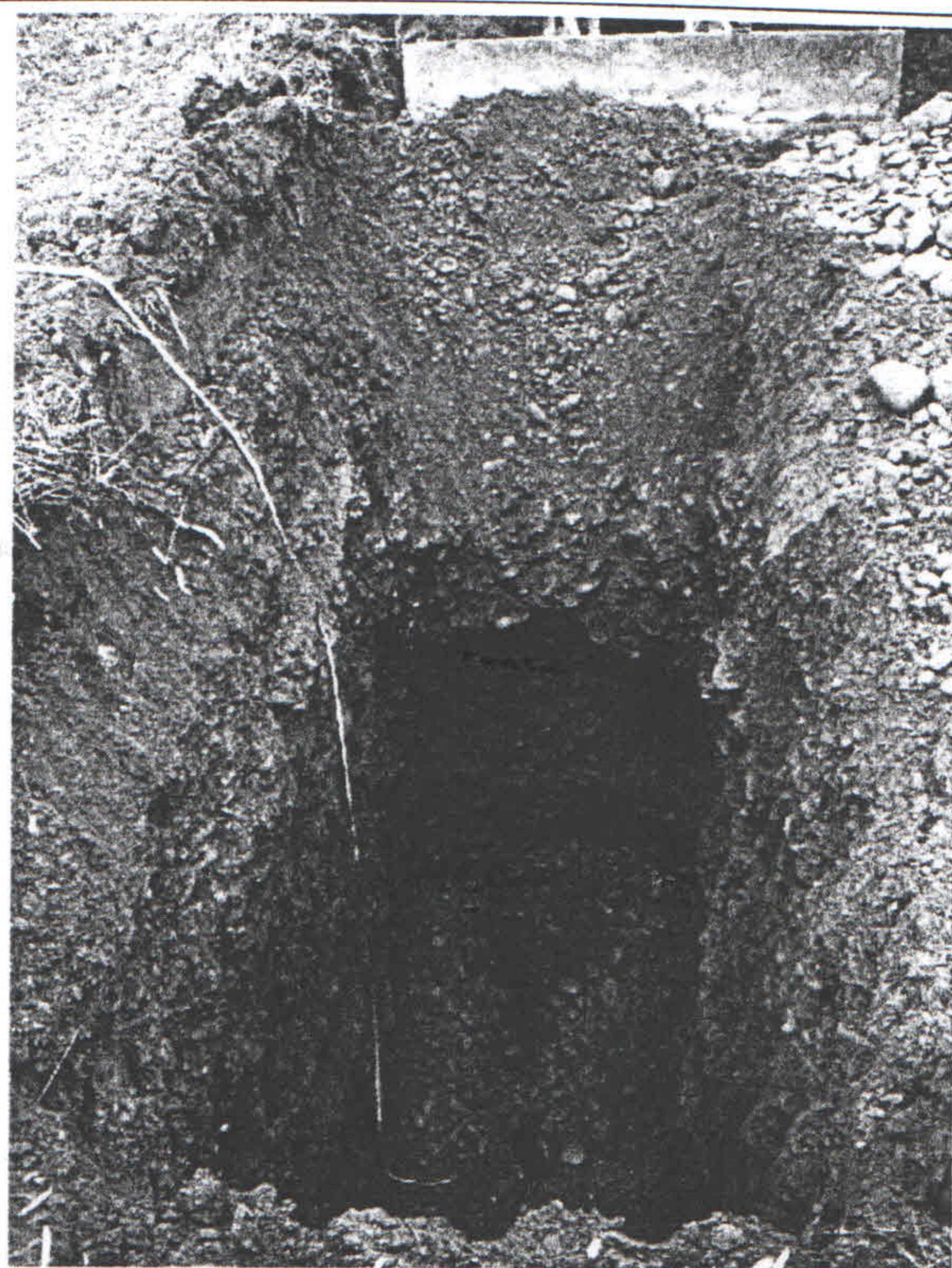
Foto 5-6: Sopra: scavo del pozzetto geognostico P3 con mezzi meccanici. Destra: particolare del pozzetto.
