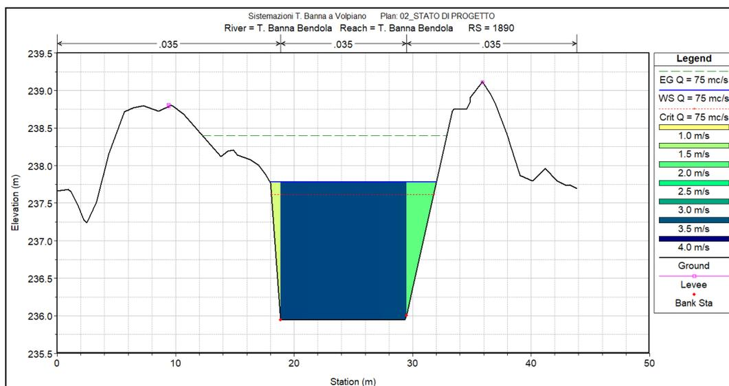
Figura 23 - Sezione idraulica di calcolo XS 1890
