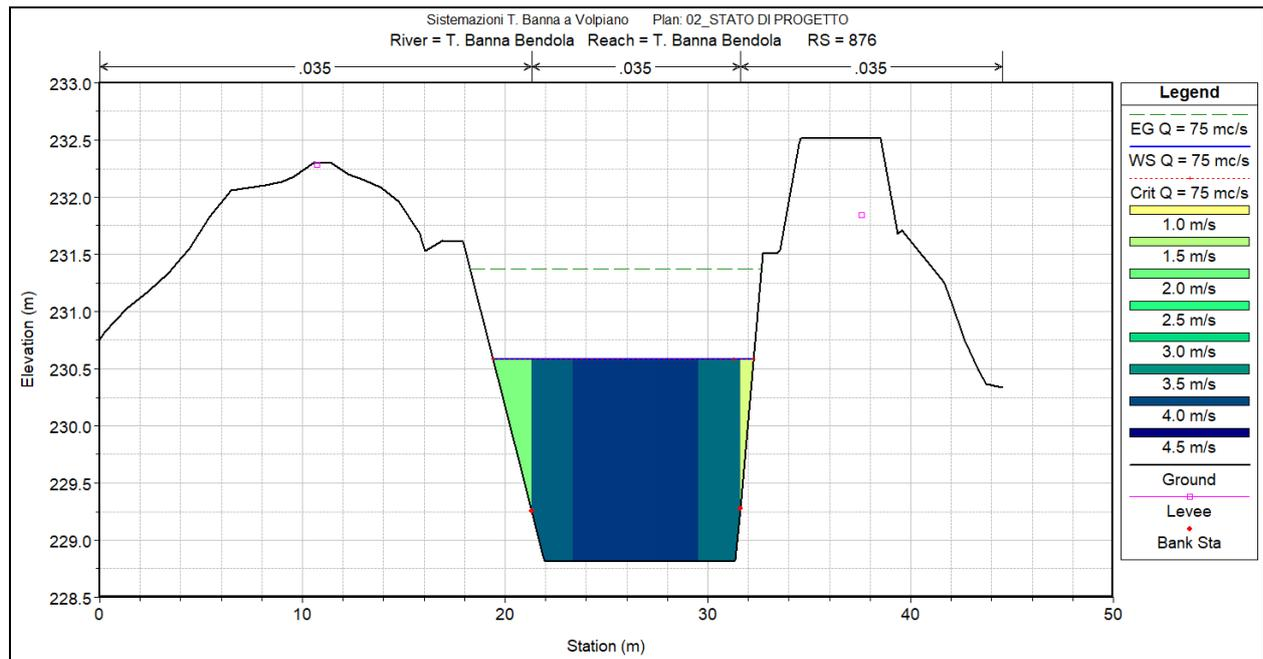
**Figura 27 - Sezione idraulica di calcolo XS 1947**
