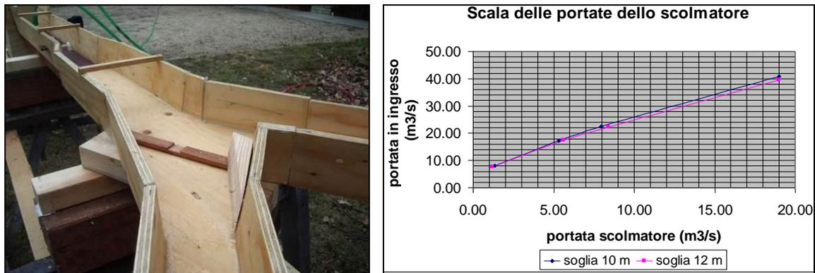
Figura 15 – Modello fisico dello scolmatore e scala di deflusso ricavata dai risultati delle simulazioni (Anselmo, 2008)
