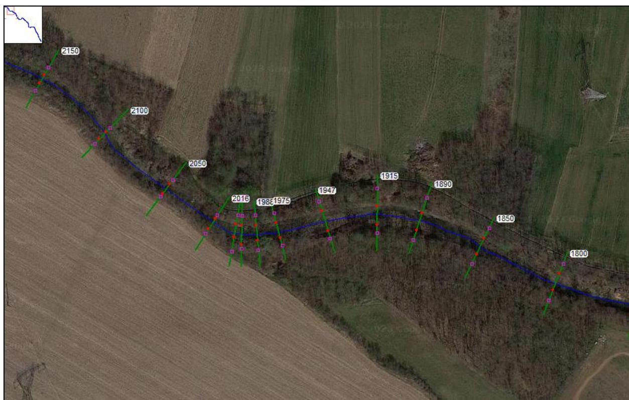
Figura 19 – Planimetria con ubicazione delle sezioni di calcolo dell'area di intervento soglia.
