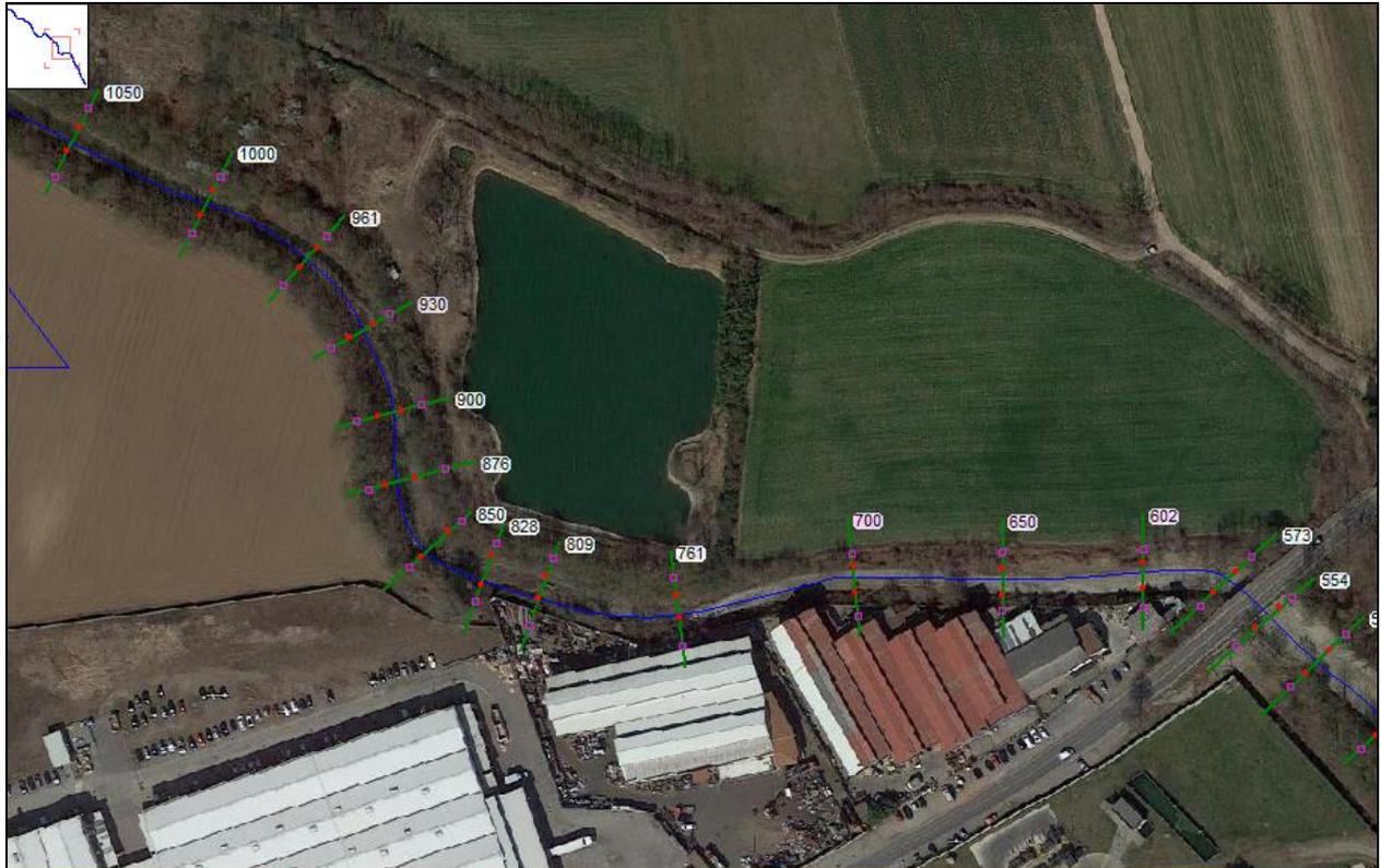
**Figura 24 – Planimetria con ubicazione delle sezioni di calcolo dell'area di intervento soglia.**
