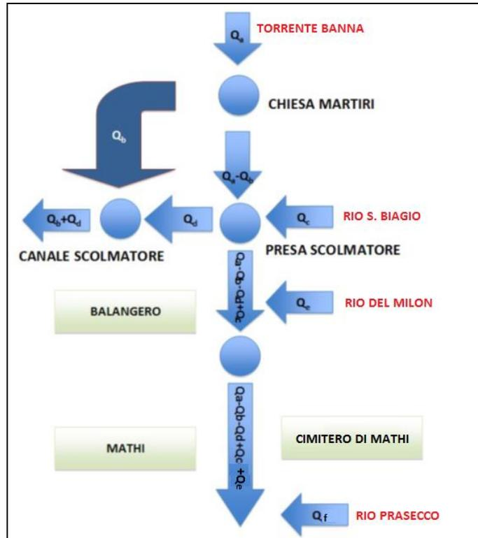
Figura 12 – Schematizzazione dei principali nodi idraulici nel tratto di monte del bacino del Banna-Bendola (Politecnico di Torino, 2009).
