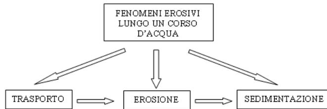
I fattori predominanti che caratterizzano ciascuno dei tre equilibri idrodinamici sono costituiti dalle caratteristiche cinematiche della corrente impattante e dalla granulometria del materiale costituente il fondo dell'alveo. Il regime idrodinamico della corrente può essere espresso attraverso il valore della velocità media nella sezione di deflusso, mentre la granulometria del materiale sottoposto all'azione erosiva viene caratterizzata con il valore del diametro medio delle particelle.
