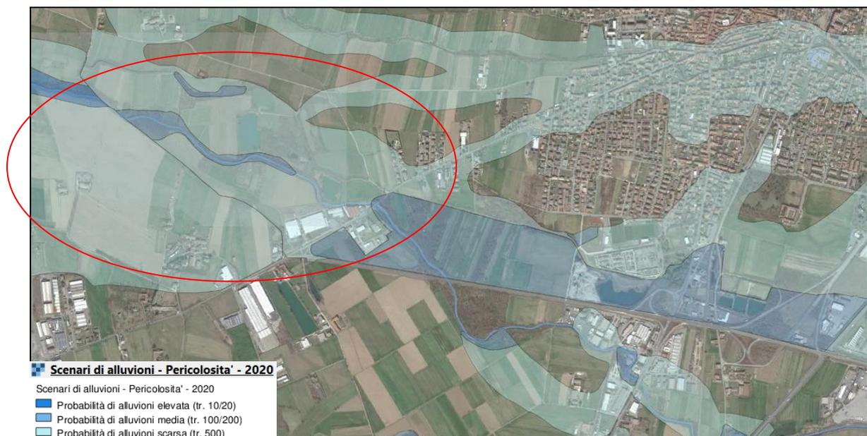
Figura 8 - Scenari di pericolosità idraulica del PGRA del 2020
