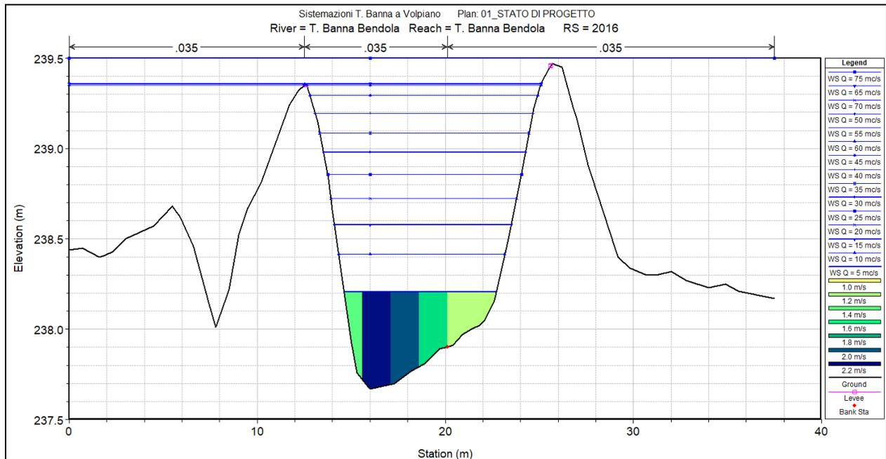
Figura 18 – Livelli calcolati al variare delle portate di piena (5 – 75 m<sup>3</sup>/s) per la XS 2016 (a monte soglia).
