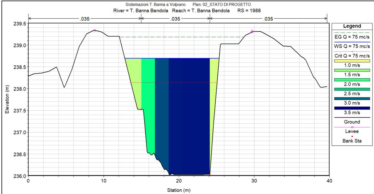
Figura 21 - Sezione idraulica di calcolo XS 1988
