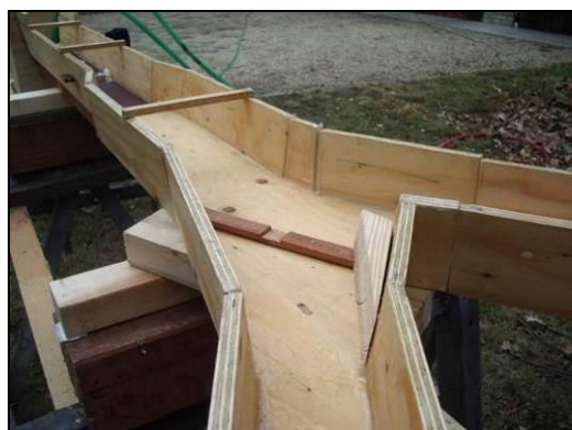
Figura 15 – Modello fisico dello scolmatore e scala di deflusso ricavata dai risultati delle simulazioni (Anselmo, 2008)
