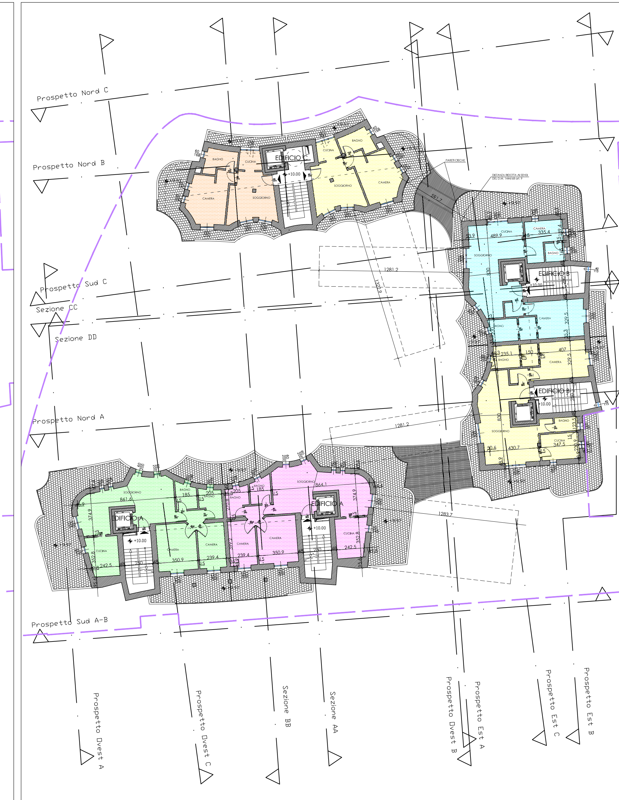
PIANTA PIANO SOTTOTETTO ABITABILE scala 1 : 200
