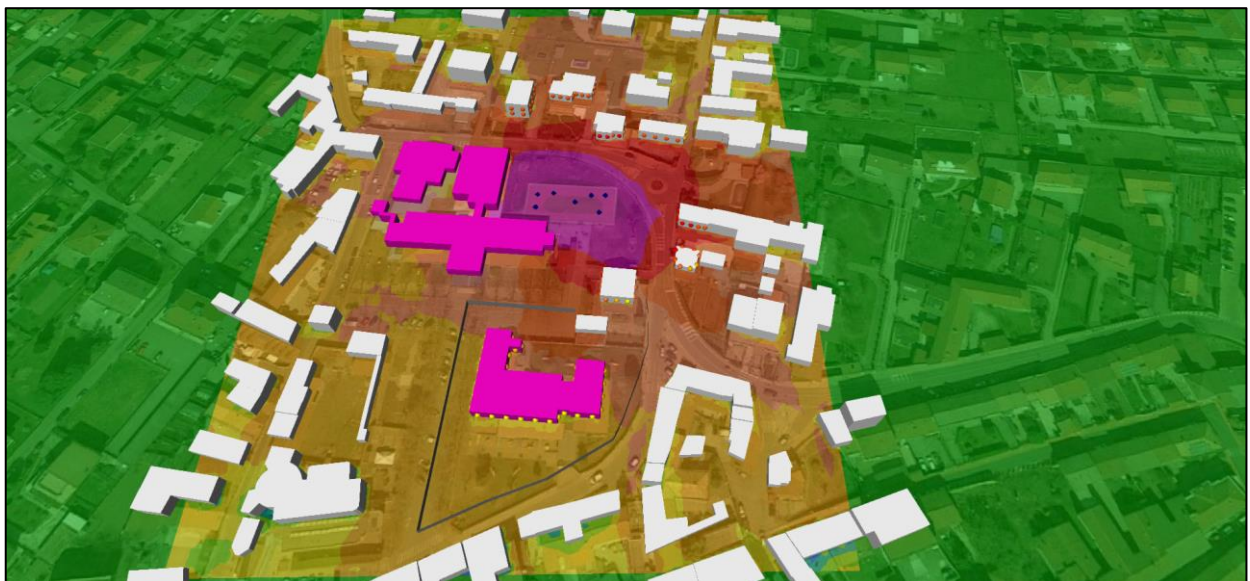
Proiezione rumorosità cantiere – Vista 3D
